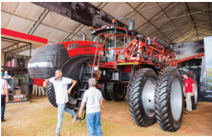
Samohodna prskalica Case opremljena gumama VF 380/105R50 HC 1000.
