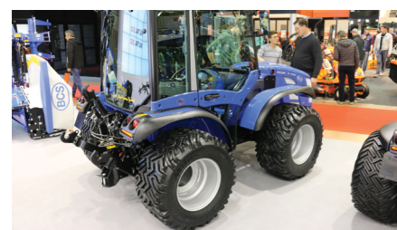
Neumáticos Mitas 440/50R17 IMP AR-04 en un tractor Volcan. Estas ruedas de tracción son idóneas para trabajar en praderas o pendientes y permiten alcanzar velocidades de 65 km/h.
